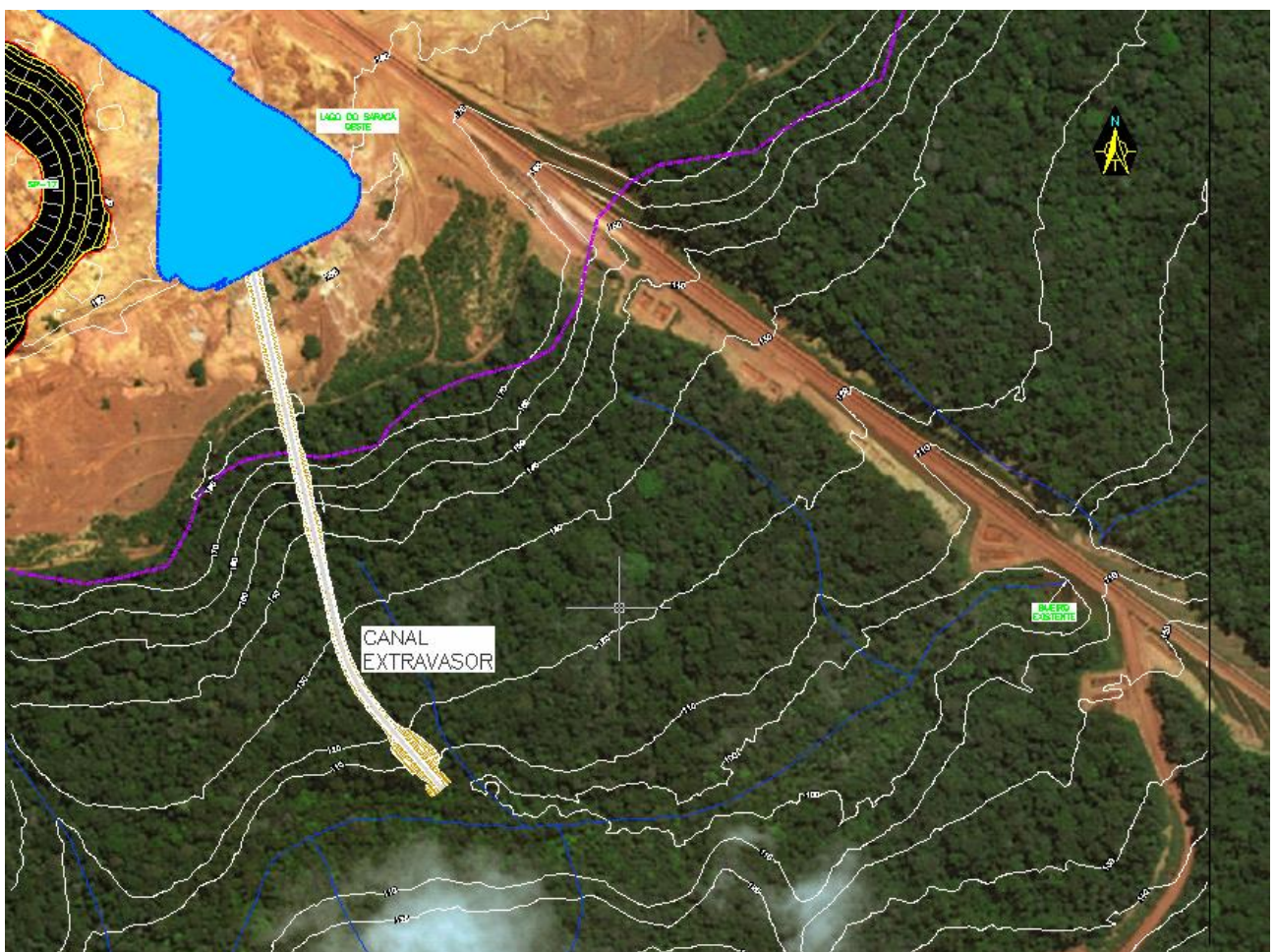
Figura 11 – Layout esquemático do extravasor de borda do Lago Saracá Oeste
